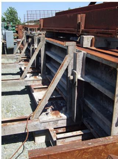
Banc de fabrication 2 poutres lg 14m Règlable en largeur 2 * 0,60 m Hauteur 0,83 m
