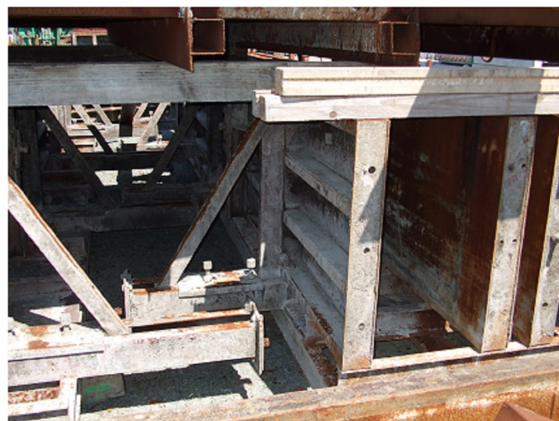
Banc de fabrication 2 poutres lg 14m Règlable en largeur 2 * 0,60 m Hauteur 0,83 m
